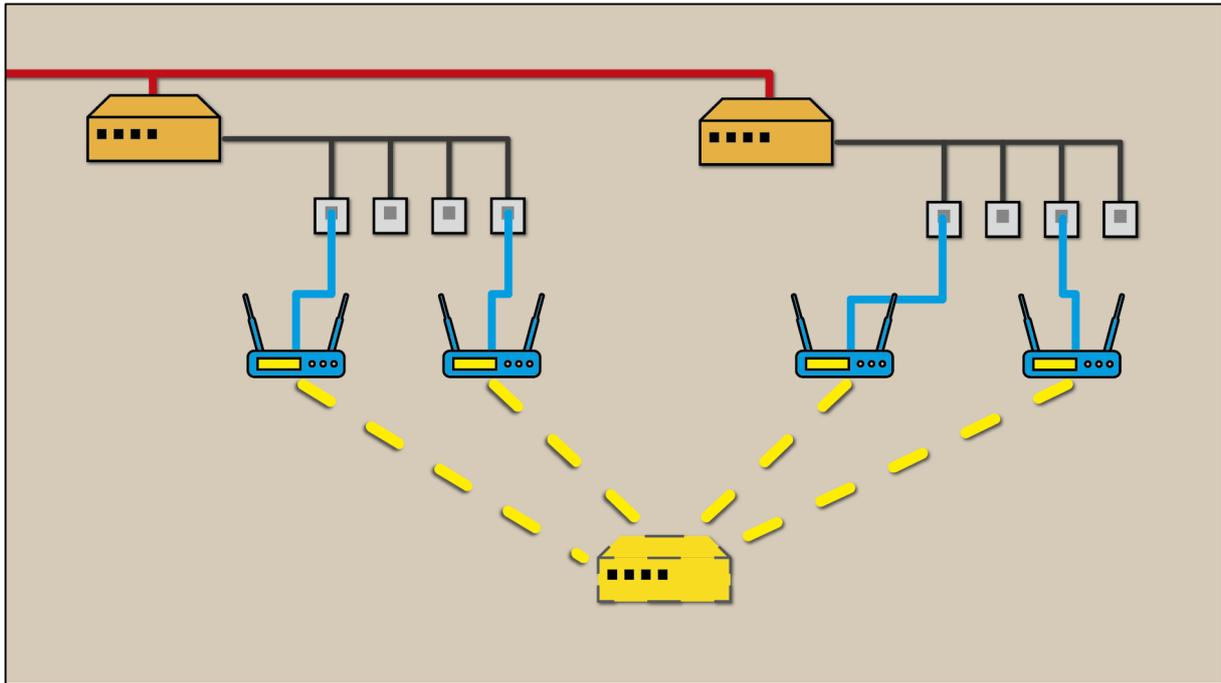
*Controllerlose Access Points virtualisieren den WLAN Controller*
